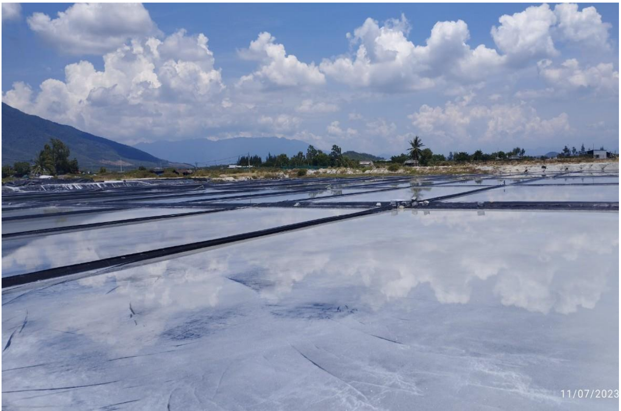
Hình 1. Khu sản xuất muối trên bạt nhựa HDPE
